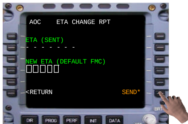
Figure 4.13: Example of ETA change MCDU page
